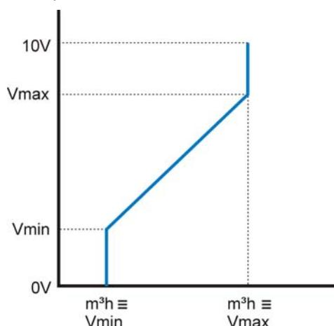
De waarde  $m^3/h \equiv V_{min}$  kan hoger of lager zijn dan  $m^3/h \equiv V_{max}$ .
