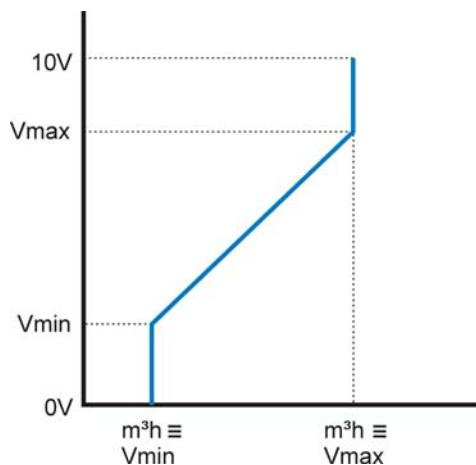
La valeur  $m^3/h \equiv V_{min}$  peut être inférieure ou supérieure à  $m^3/h \equiv V_{max}$ . Via le setup avancé il est possible d'arrêter le(s) ventilateur(s) si le signal d'entrée est inférieur et/ou supérieur à une limite donnée.
